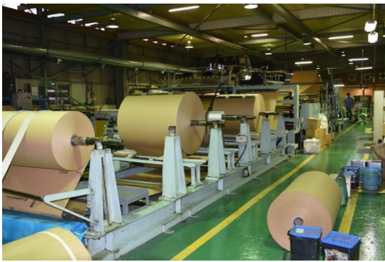
巨大なロールから印刷と裁断が始まる工程
